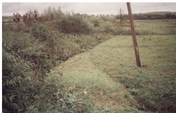
Figura 9: Refularea terenului de bază
